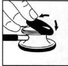
Para montar la goma quitafrío, coloque una parte de la funda en el borde de la pieza torácica y estírela sobre y alrededor del borde de la misma.
