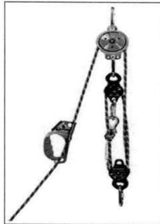
**Equipo preensamblado:** es un equipo que ofrece la opción de rescate de descenso controlado, la evacuación o la versatilidad de rescate asistido con capacidades de elevación. Es totalmente automático característica descenso controlado, de 2-3 pies por / segundo (0,6 a 0,9 m), capacidad para un usuario de 310 libras (140 kg).
